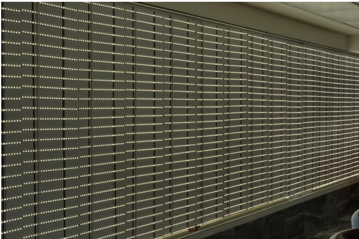
Test dell'insegna 11x2 mt priva del tessuto stampato con i moduli Velarium™ accesi.
